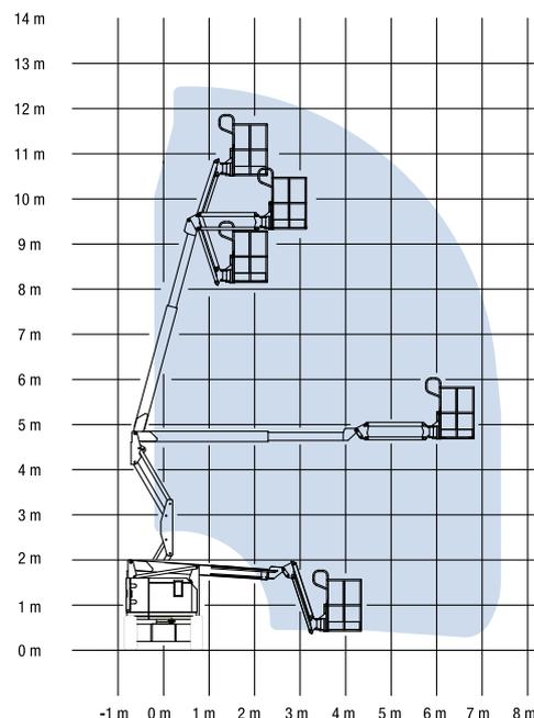
\* Altura de trabajo = Altura de la plataforma + 1,80 m
