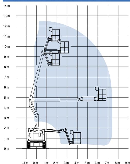
\* Altura de trabajo = Altura de la plataforma + 1,80 m
